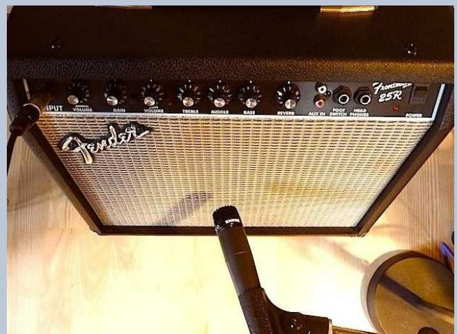
En SM57 og en Royer 101 pegende skråt mod siden af højtaleren. Den tætte placering eliminerer rummets akustik. En anden mulighed er at placere SM57 helt tæt og R-101 på større afstand. I begge opsætninger kan Royer 101 udskiftes med en kondensatormikrofon eller helt udelades som på billedet til højre.
